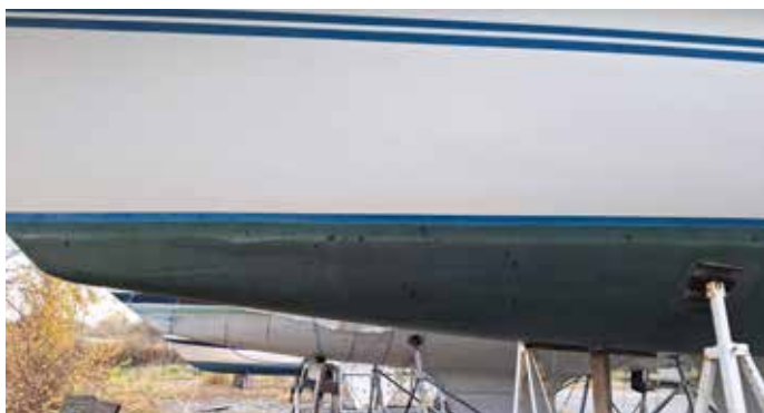
Kopparläckage 0,8 mikrogram/cm 2 , zinkläckage 0 mikrogram/cm 2 . Testad år 2025.
