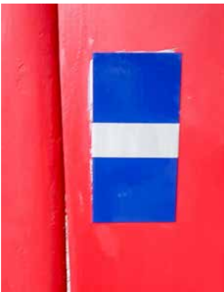
Exempel på testplåt före sjösättning, limmad på ett roder. Plåtarna har måtten 10x20 cm.
