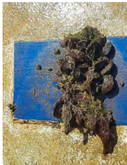
Testplåt direkt efter upptagning på hösten, före avspolning med högttryckstvätt.
