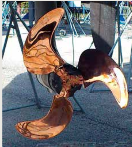
Foldingpropeller på segelbåtsdrev. Bladen är nyligen förkopprade, men inte navet som däremot är målat med antifoulingfärg.
