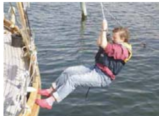
Hissprov med fall till skotvinsch via kastblock.
