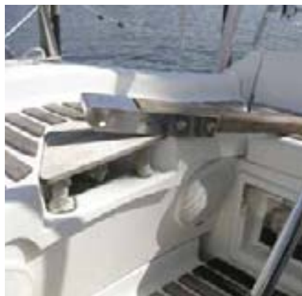
Reservrorkult i rattstyrd båt. Rorkulten kopplas till hjärtstockens topp under teakplattan i centerlinjen.
