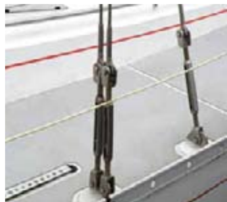
Vantskruvar säkrade med saxpinnar. Bra vinkel i röstjärnen gör att inga toggles behövs. Foto Ingemar Pålsson
