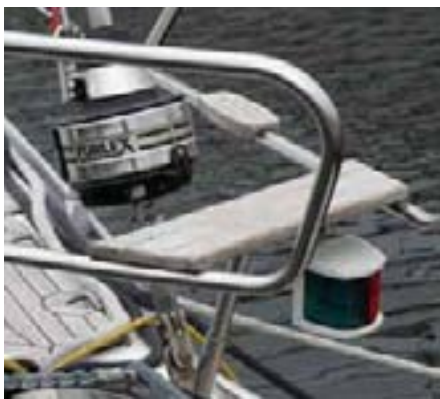
Försegelrulle med en toggle i förstagsfästet. Sprintarna säkrade med saxpinnar. Foto Ingemar Pålsson
