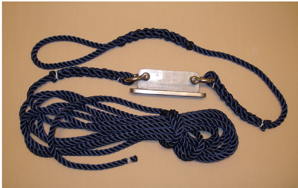
Exempel på ett masthanhissningsbeslag för segelrännan. Beslagets längd är anpassad efter rännans öppning vid segelintaget. Lyftögla och lång, stark lina som kan beläggas runt masten under winscharna, till exempel.
