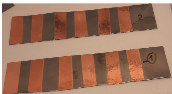
Figur 4 Försöksuppställning för målning av stålplatta med 100 \mu\text{m} färglagertjocklek definierade av koppartejpens tjocklek.
