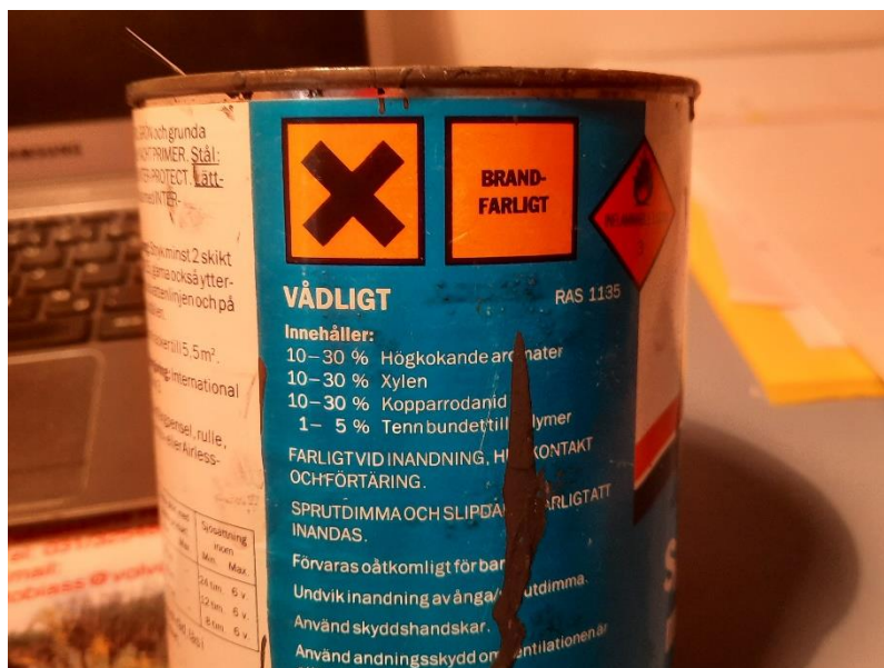
Figur 3 Den TBT-färg som användes i försöken (1-5% tenn bundet till polymer).
