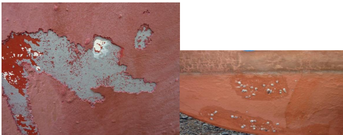
Figur 7. Till vänster, exempel på tjockt färglager. Totalt skiktlager på denna båt är ca 800 \mu\text{m} . Det grå är epoxi och resten kopparfärg. Till höger en båt med TBT-färg som bättrats med kopparfärg där havstulpaner verkar trivas.
