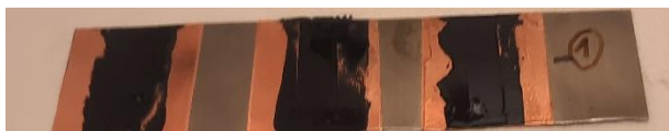
Figur 10 Området mellan koppartejpen (i figur 4) som målats med planstrykare för att få rätt färgskiktjocklek
