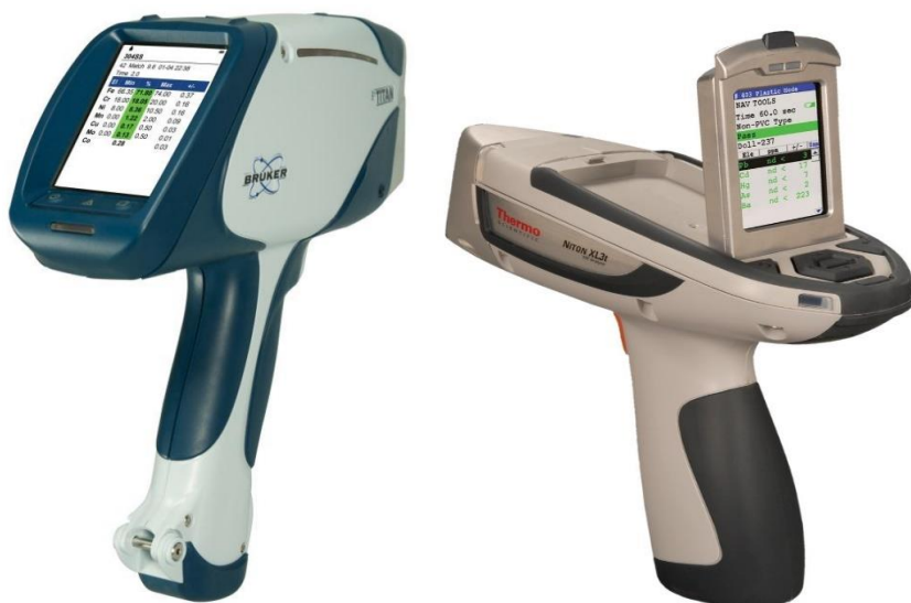
Figur 2. De handhållna XRF-instrumenten som använts vid undersökningarna, Bruker Titan x till vänster kalibrerad i ppm och Thermo Niton XL3t till höger kalibrerad i \mu\text{g}/\text{cm}^2 .
