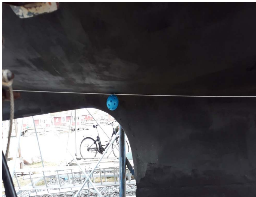
Figur 5. Placering av DGT-provtagare runt ett skrov som målats med kopparfärg
