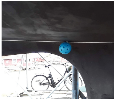
Fyra DTG-sonder monterades i varsin innebandyboll på fyra ställen intill den nymålade kopparfärgen.
