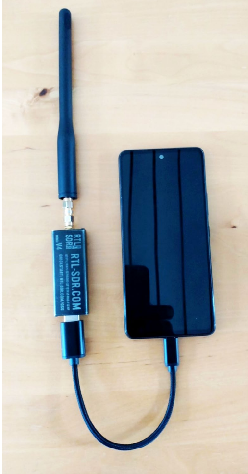
Figur 1. En RTL-SDR, med antenn och kopplad till en telefon med en "USB-C Host Mode"-kabel.
