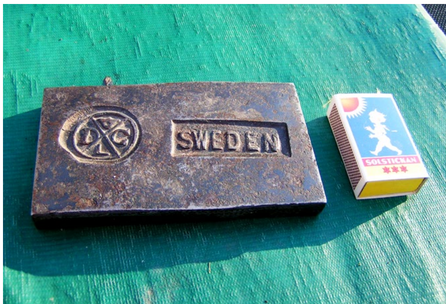
En bit stångjärn med stämpel som visade namnet på tillverkaren, i detta fall Karlholmsbruk. Den fulla längden på ett stångjärn var ca 4 m. Foto Kjell Pernestål.
