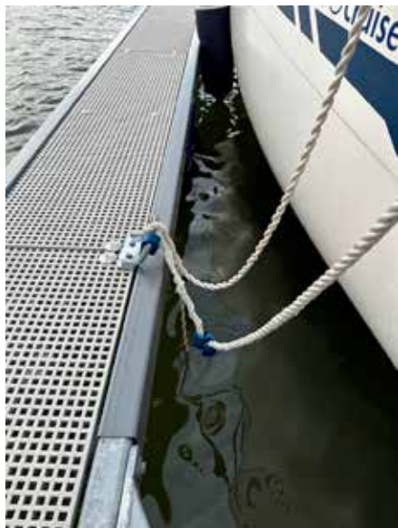
Båt på vinterplats med ryckdämpare på dubblerad lina. Linan har rört sig i förtöjningsbygeln som har skavt av en hel kardel och skadat de övriga två.
