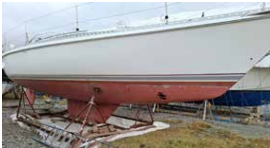
Kopparläckage 1,0 mikrogram/ \text{cm}^2 , zinkläckage 1,1 mikrogram/ \text{cm}^2 . Testad år 2025
