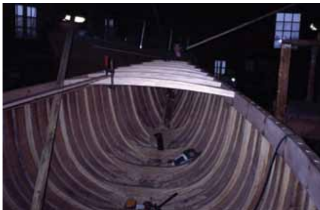
En bild som visar spantsektionerna, samt hur tätt spantad båten är
